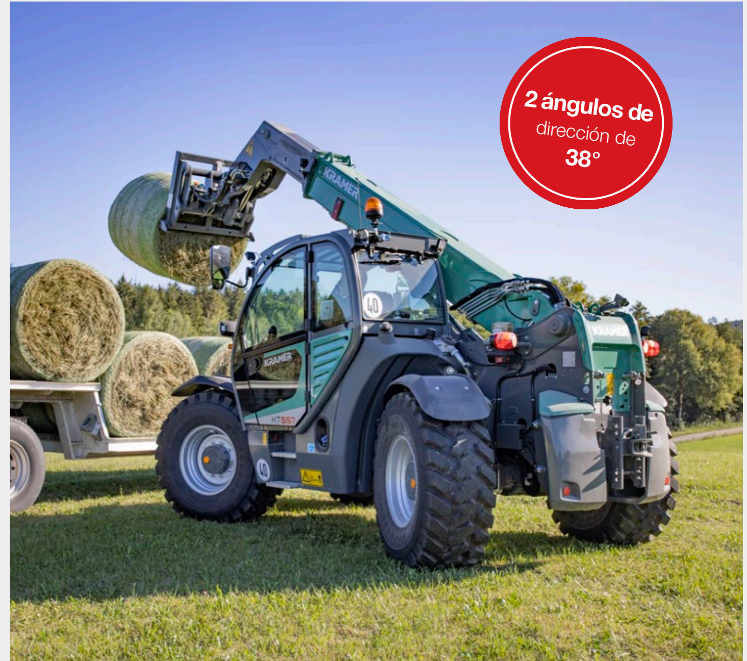
Dirección a las cuatro ruedas para la máxima maniobrabilidad
