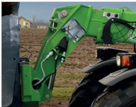
Tuyauteries, câbles électriques et lignes hydrauliques auxiliaires sont logés à l'intérieur de la flèche.
