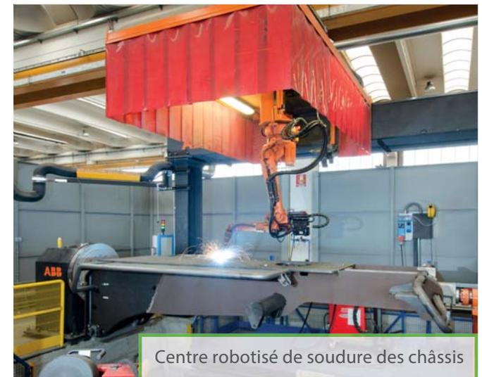
Centre robotisé de soudure des châssis
