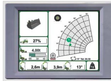
Le système MDCD vérifie en temps réel les conditions de stabilité longitudinale et fournit à l'opérateur l'indication du pourcentage d'exploitation de la condition de stabilité maximale.
